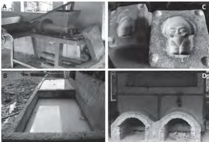
Figura 48. Herramientas y medios utilizados por los artesanos Hermanos Guillén en los procesos de confección alfarera. A. Máquina para moler el barro; B. Tanques para almacenar y mantener húmedo el barro; C. Moldes para dar forma inicial a la figura Diosa Luna; D. Horno. Fotografía de Jorge Ulloa Hung.
