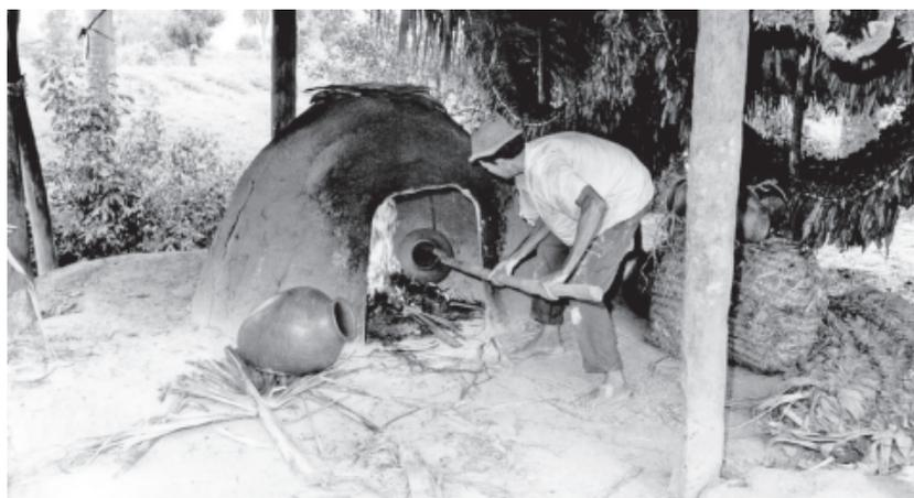
Figura 37. El «quemador» Clemente Cáceres introduce una tinaja en el horno. Aquí se ilustra la presencia de la figura masculina en esta parte del proceso. Foto Manuel García Arévalo.
