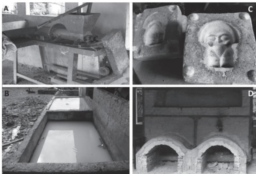
Figura 48. Herramientas y medios utilizados por los artesanos Hermanos Guíllén en los procesos de confección alfarera. A. Máquina para moler el barro; B. Tanques para almacenar y mantener húmedo el barro; C. Moldes para dar forma inicial a la figura Diosa Luna; D. Horno. Fotografía de Jorge Ulloa Hung.
