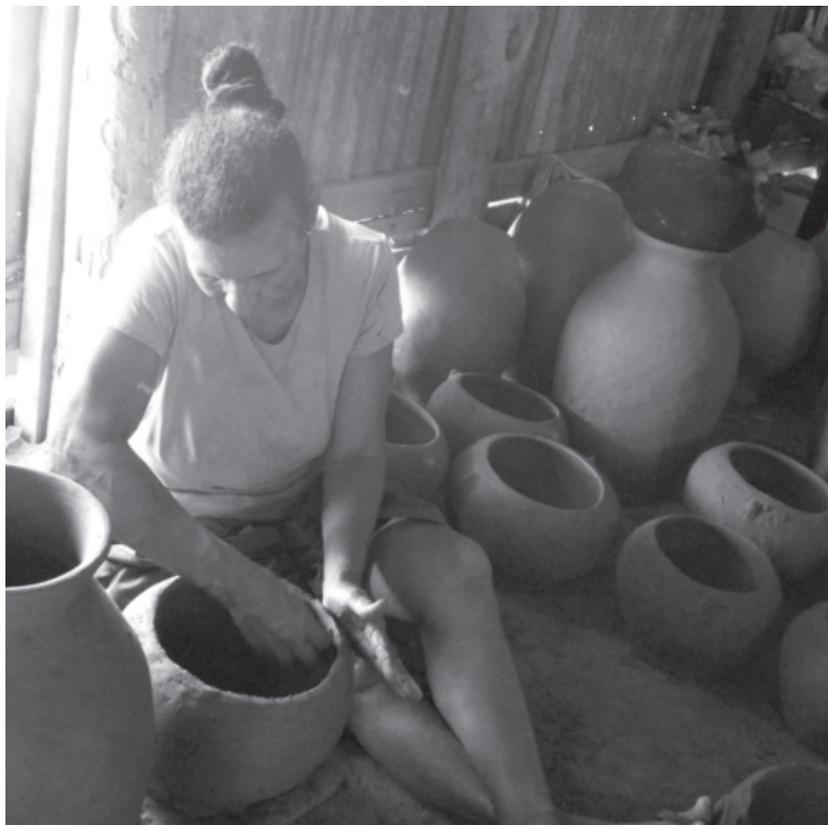
Figura 41. La artesana Gloria Lora mientras trabaja en el borde de una olla utilizando técnicas tradicionales. Higüerito, Moca. Fotografía de Jorge Ulloa Hung.
