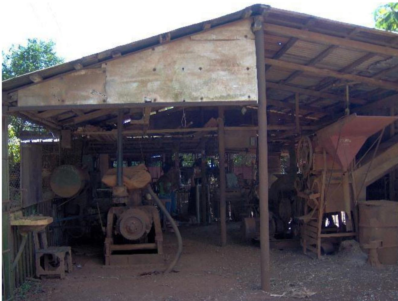
**FIG. 1.** Molino para proceso de separación del grano (izquierda) y máquina para separar el maní de la cáscara (derecha), en La Salud, provincia de Mayabeque
