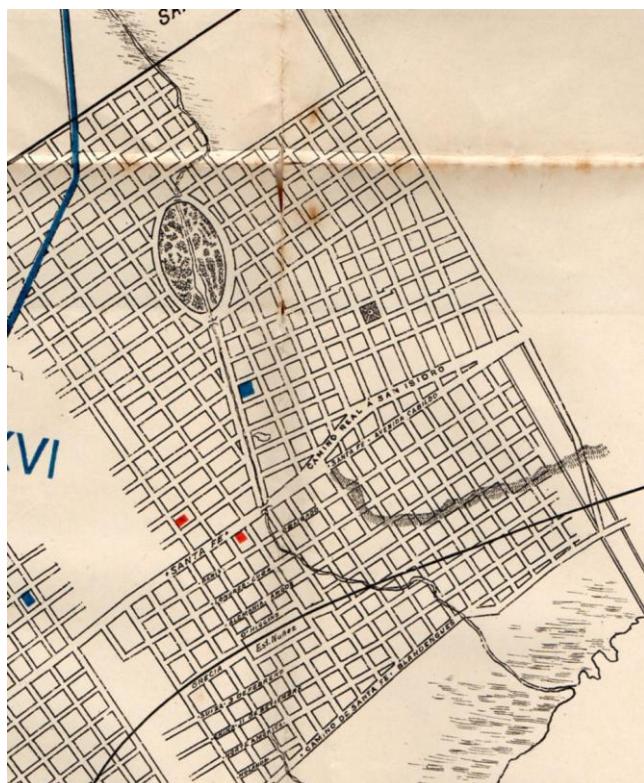
FIG. 9. Plano en que se observa que la calle Besares en el tramo estudiado coincide con parte de la antigua barranca al río, cerca del arroyo Medrano en ese época al aire libre y el desvío de la Calle Real para salvar el desnivel, posible explicación de la presencia de rellenos (Plano: Estadística Escolar de la Nación , 1897)
