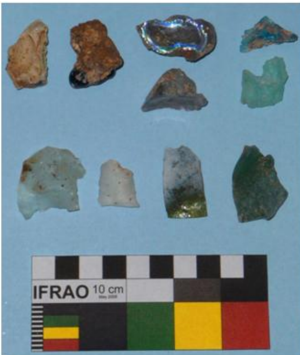
FIG. 5. Termooalteración en las piezas de CF. Ejemplares deformados abajo, y escorias vítreas arriba
