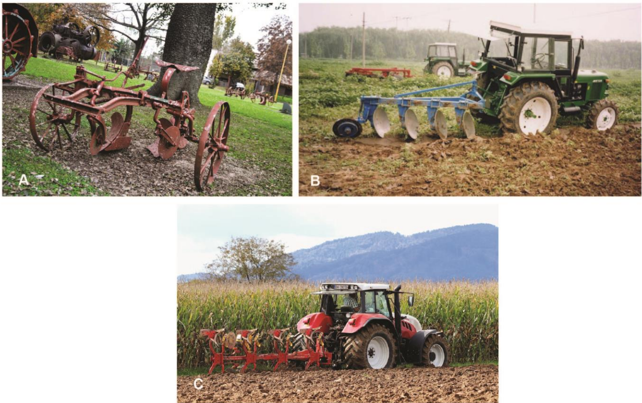
FIG. 4. Diversos tipos de arados utilizados en los campos pampeanos. A. Arado de reja. B. Arado de disco. C. Arado de cincel
