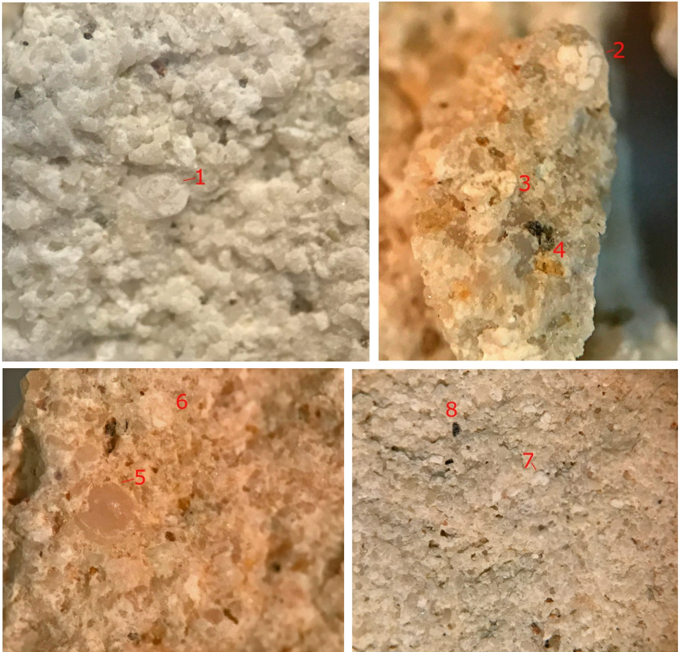
FIG. 5. Microfotografías de la muestra analizada del blasón. Los números indican clastos y microfósiles de foraminíferos. Número 1, 6 y 7: Asterigerina cf. carinata . Números 2 y 3 son Ammonia o Elphidium . Número 4 y 8, fragmentos de metales pesados (naturales) del conglomerado. Numero 5: Amphistegina cf. gibosa . Nótese la porosidad y poca cementación de la matriz
